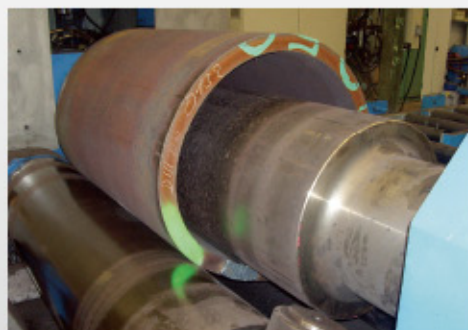
校圆时, 焊缝不同时与 2 个辊子接触
