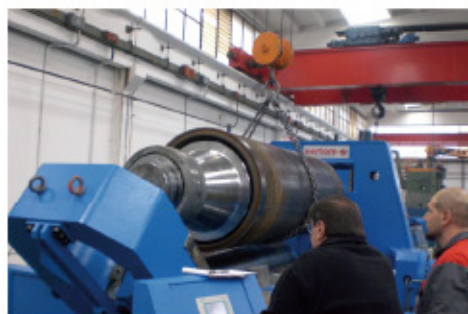
侧开取出机构, 管径 \geq 1.15 倍上辊直径
