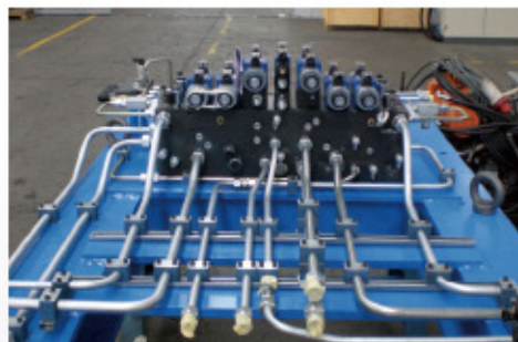
整体式的主阀体是 SERTOM 自制的、使用金属管, 最大限度降低故障发生的可能
