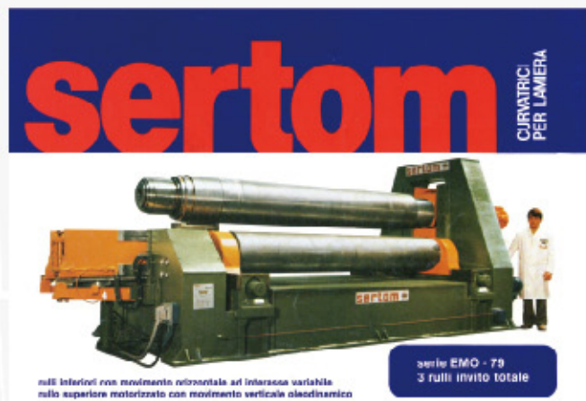
1976 年世界第一台三辊水平下调可变距卷板机诞生于 SERTOM
